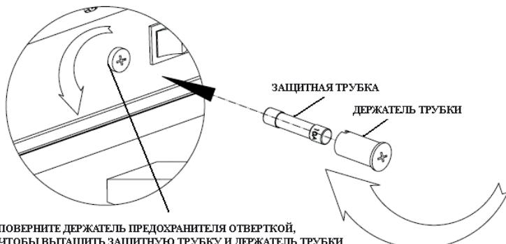
ПОВЕРНТЕ ДЕРЖАТЕЛЬ ПРЕДОХРАНИТЕЛЯ ОТВЕРТКОЙ,
